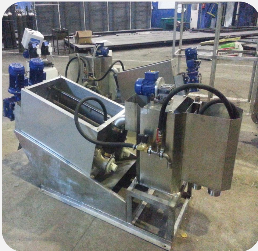
Шнековый обезвоживатель TURAN-Ш 130/2 Заказчик: ООО «Мелн» г. Воронеж Молочный комбинат Производительность 4 м 3 /час
