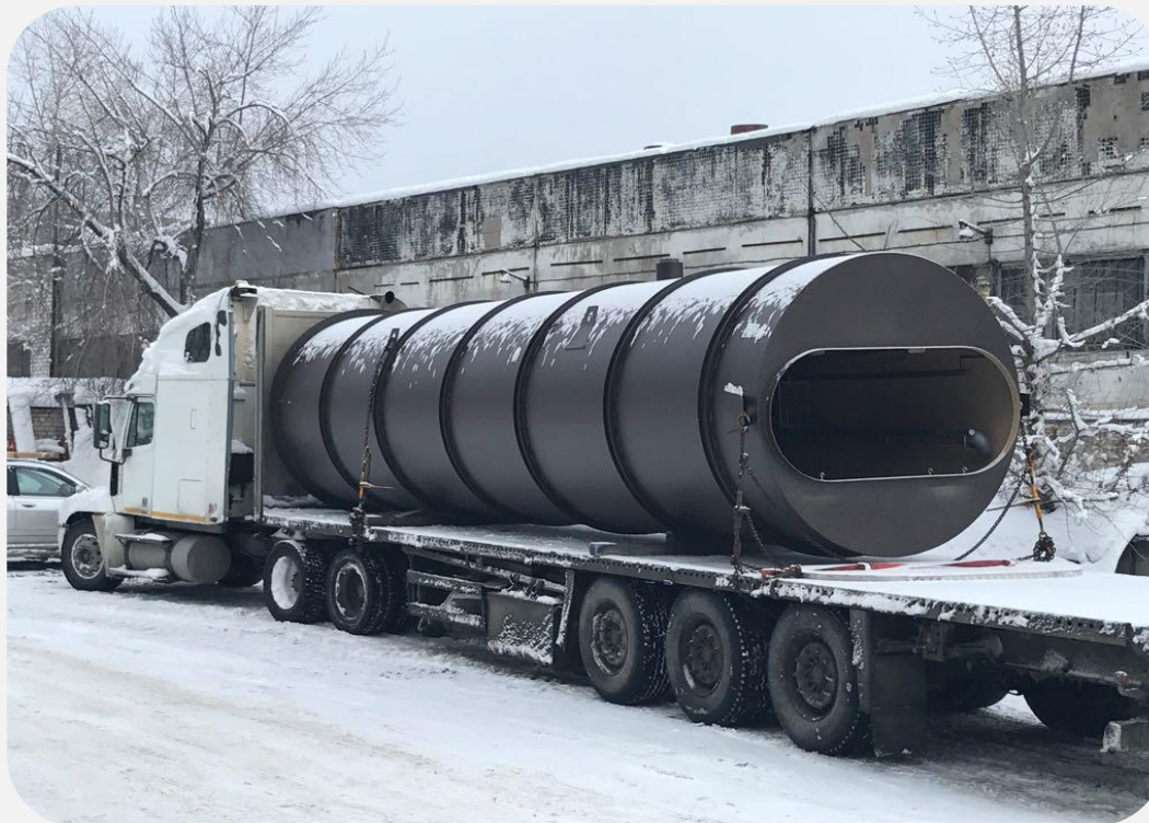
Канализационная Насосная Станция ПРОТОКА-10 Заказчик: ООО «Гидронефтестрой» Кемеровская область Производительность 10 м 3 /час. Напор 15м.
