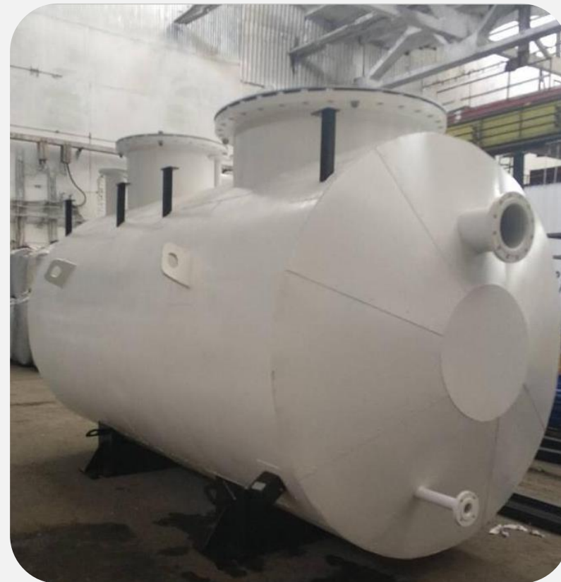
Емкость LIMAN-X 10 под кислоту Заказчик: ООО «Электа» г. Москва Объем 10 м 3
