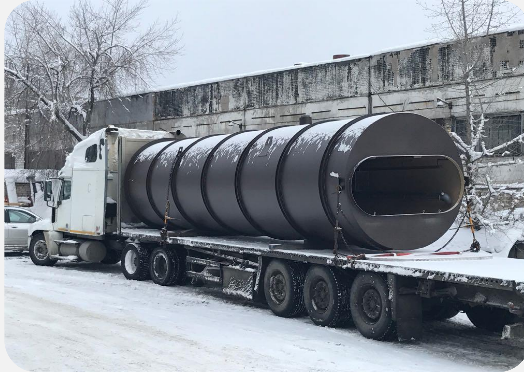
Канализационная Насосная Станция КНС-10 Заказчик: ООО «Гидронефтестрой» Кемеровская область Производительность 10 м 3 /час. Напор 15м.
