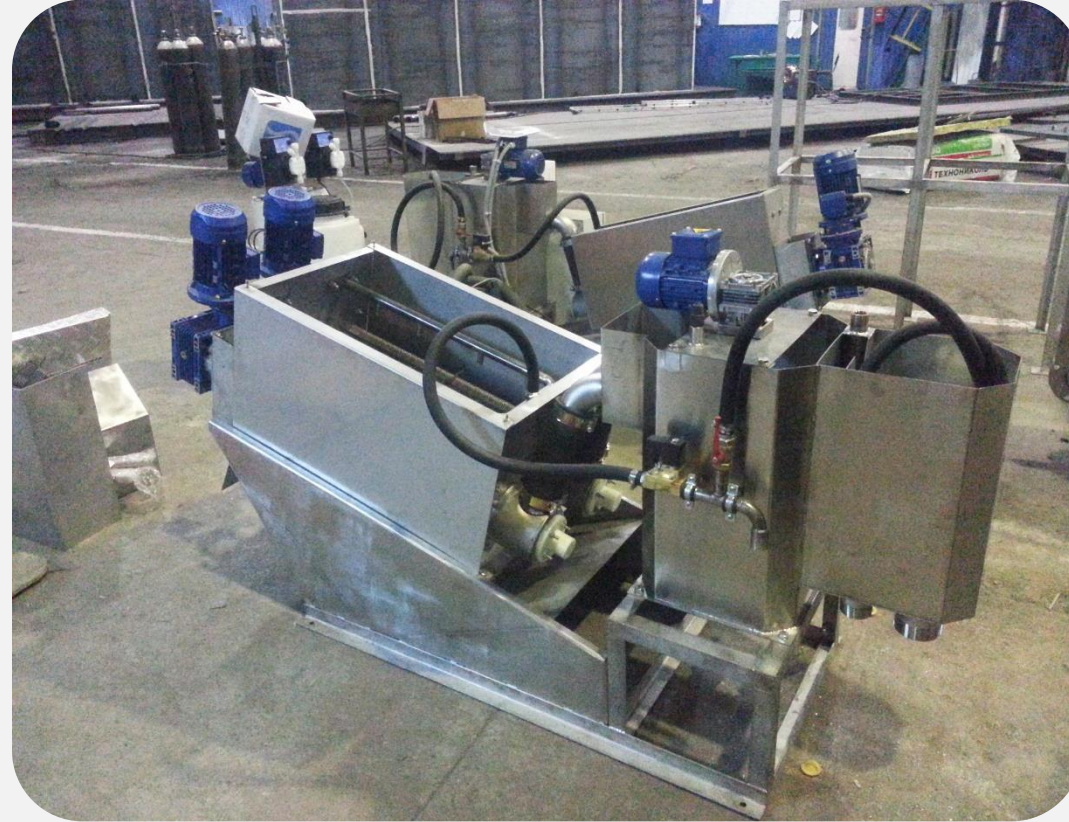
Шнековый обезвоживатель СО-Ш 130/2 Заказчик: ООО «АГВОР» поставка на объект компании АО «Газпром» Производительность 4 м 3 /час
