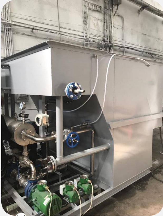
Флотационная установка ТР-5В взрывозащищенное исполнение Заказчик: АО «Транснефть-Сибирь» Тюменская БПТО и КО Производительность 5 м 3 /час
