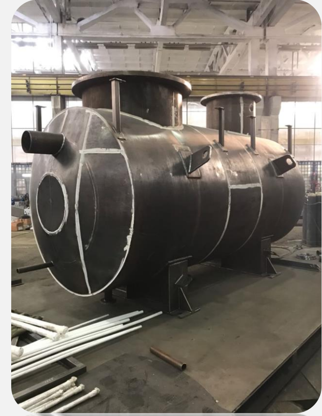
Емкость ЕМ-Х 10 под кислоту Заказчик: ООО «Электа» г. Москва Объем 10 м 3
